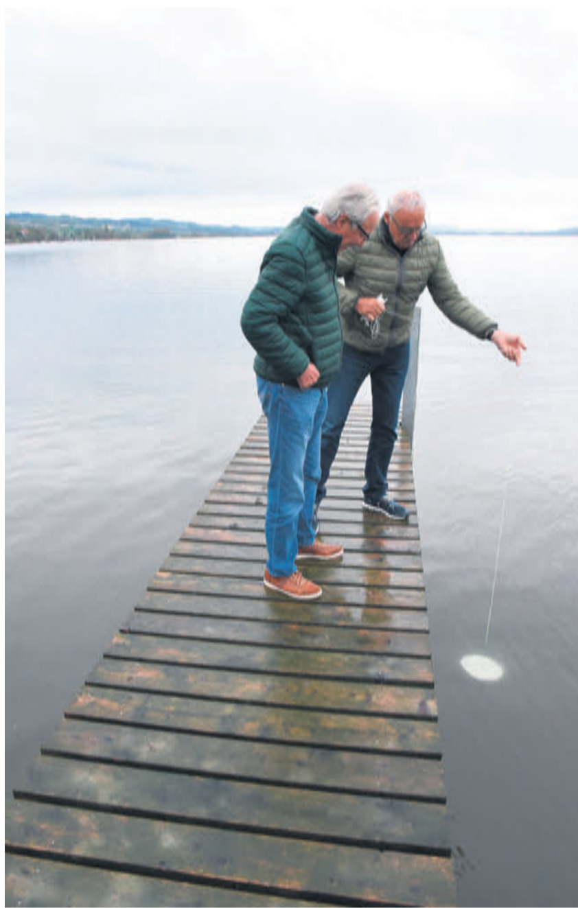
Josef Blum (links) und Franz Schwegler begutachten das Algenvorkommen im Wasser mithilfe einer Secchi-Scheibe, die die Sichttiefe misst. FOTO GERI WYSS
